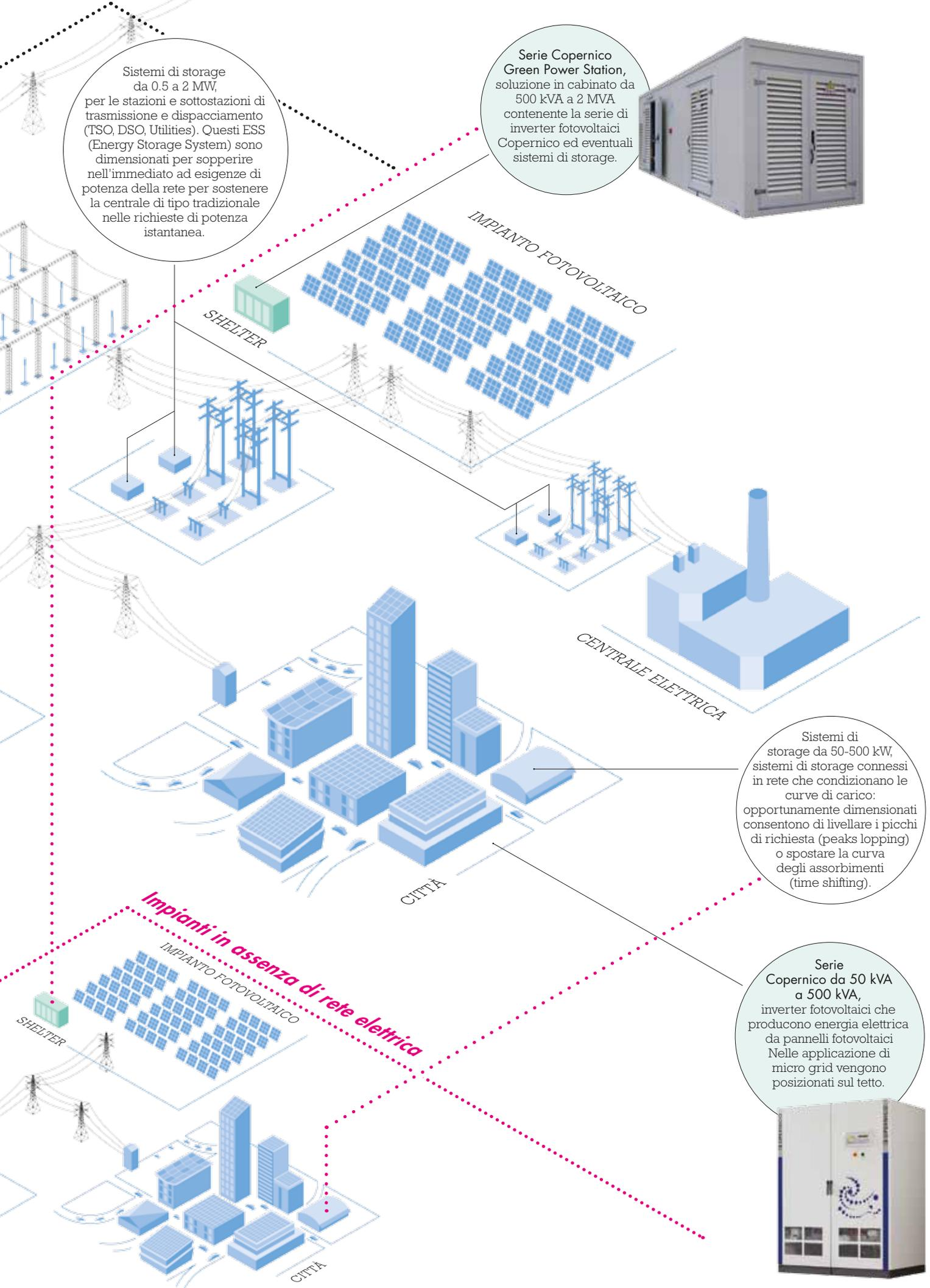
Sistemi di storage da 50-500 kW, sistemi di storage connessi in rete che condizionano le curve di carico: opportunamente dimensionati consentono di livellare i picchi di richiesta (peaks lopping) o spostare la curva degli assorbimenti (time shifting).
